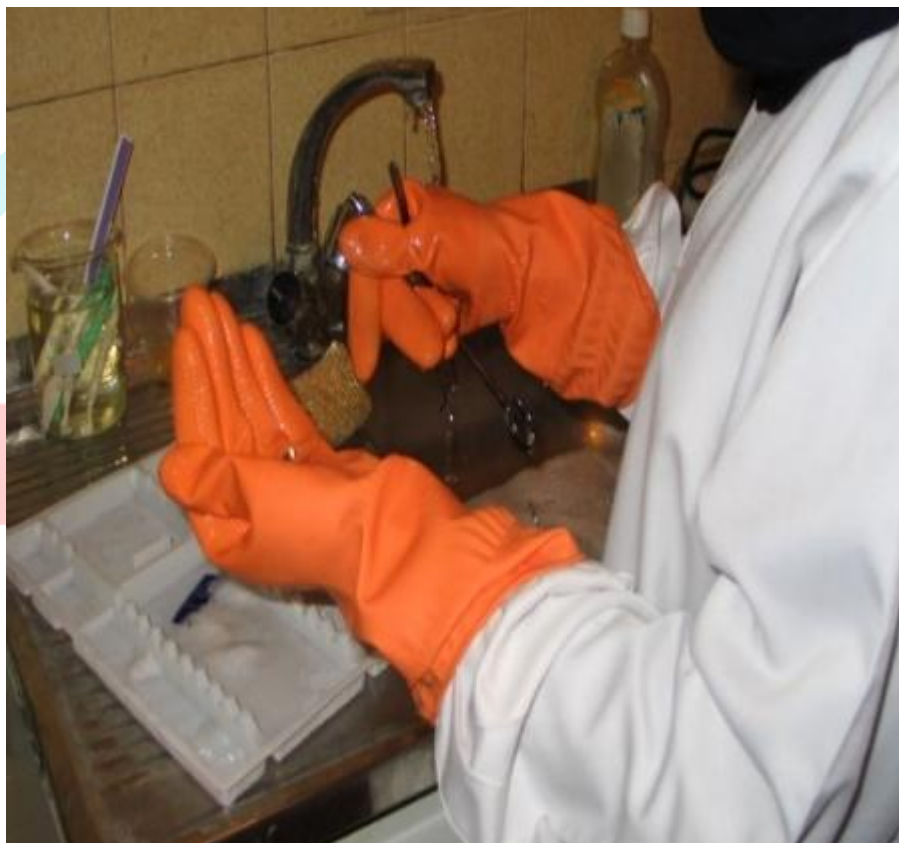
شکل ۱۲-۹. استفاده از دستکش ضخیم برای تمیز کردن وسایل
